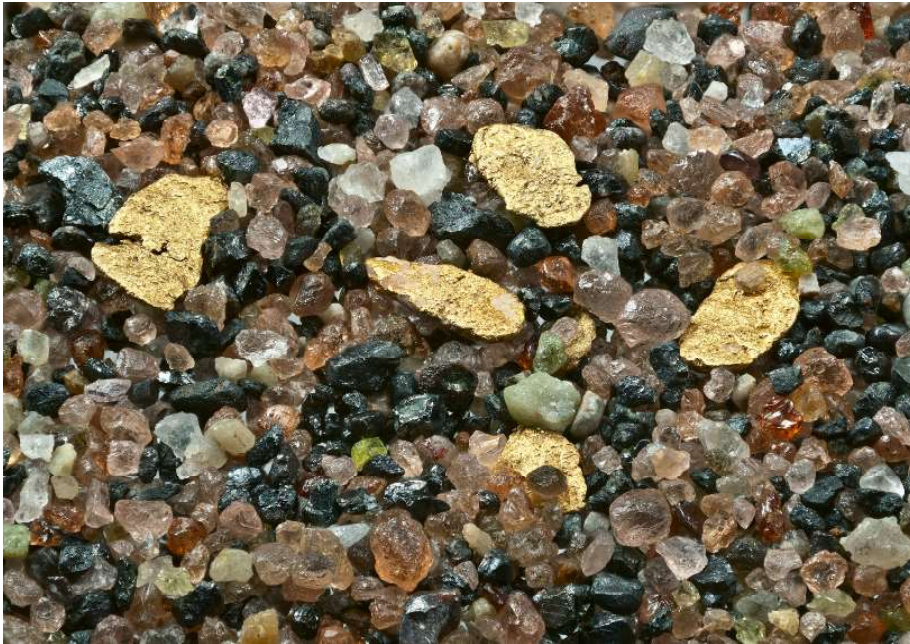
Abbildung 5: Gold mit begleitenden Schwer- mineralen (schwarz = Magnetit, braunschwarz = Ilmenit, rot = Granat, farblos = Zirkon). Sammlung: V. Jans (Foto: Th. Schüpbach)
